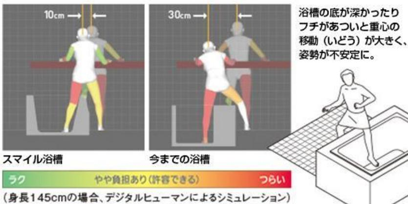
さらに、またぐところを従来の浴槽より中央部で高さを 50mm 低く、厚みを 40mm 薄くし、洗い場床と浴槽床の高低差を少なくして、ラクに安定した姿勢で出入りができるようにしました。
