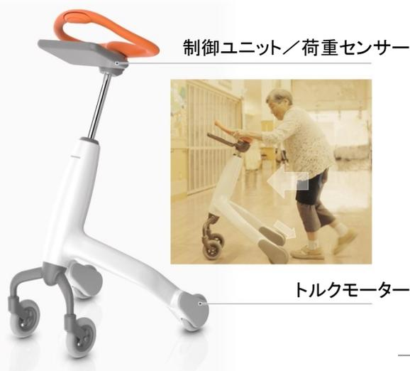
図1: 運動負荷をかける仕組み
