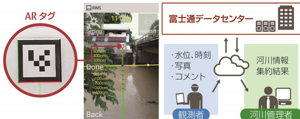
インフラ未整備の地域へ対応した水位観測の仕組み
