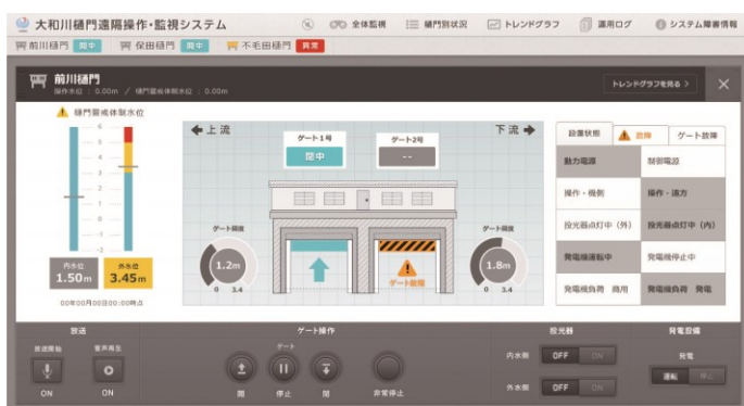
安全に水門の開閉をコントロールできる WEB 操作画面（写真は実際の樋門とは異なります）
