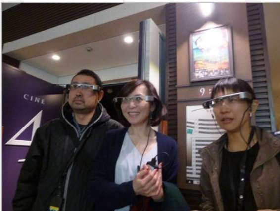
スマートグラスを装着した様子 胸に見える端末に字幕データが記録されている
