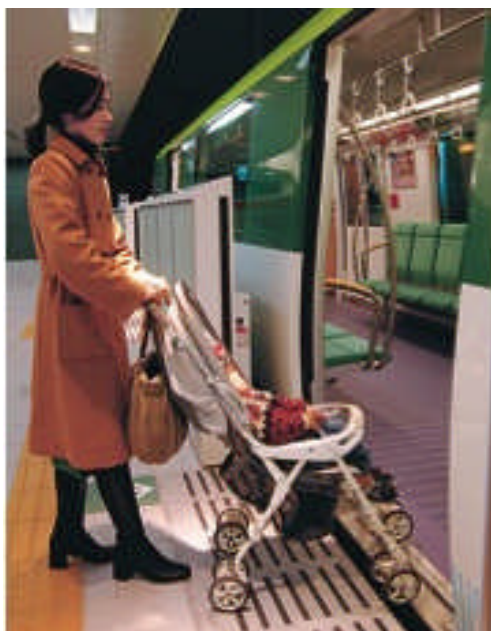
福岡・七隈線 ベビーカーの赤ちゃん連れの女性がホームから電車に乗り込むところ。 進路は素材と色に変化をつけているが、乗り降りは完全に平坦ですきまは小さい。
