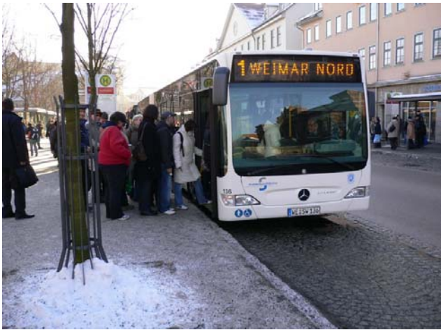
ベンツ製の連結バスはバス停に止まると車高が低くなり乗降しやすくなる（ワイマール）
